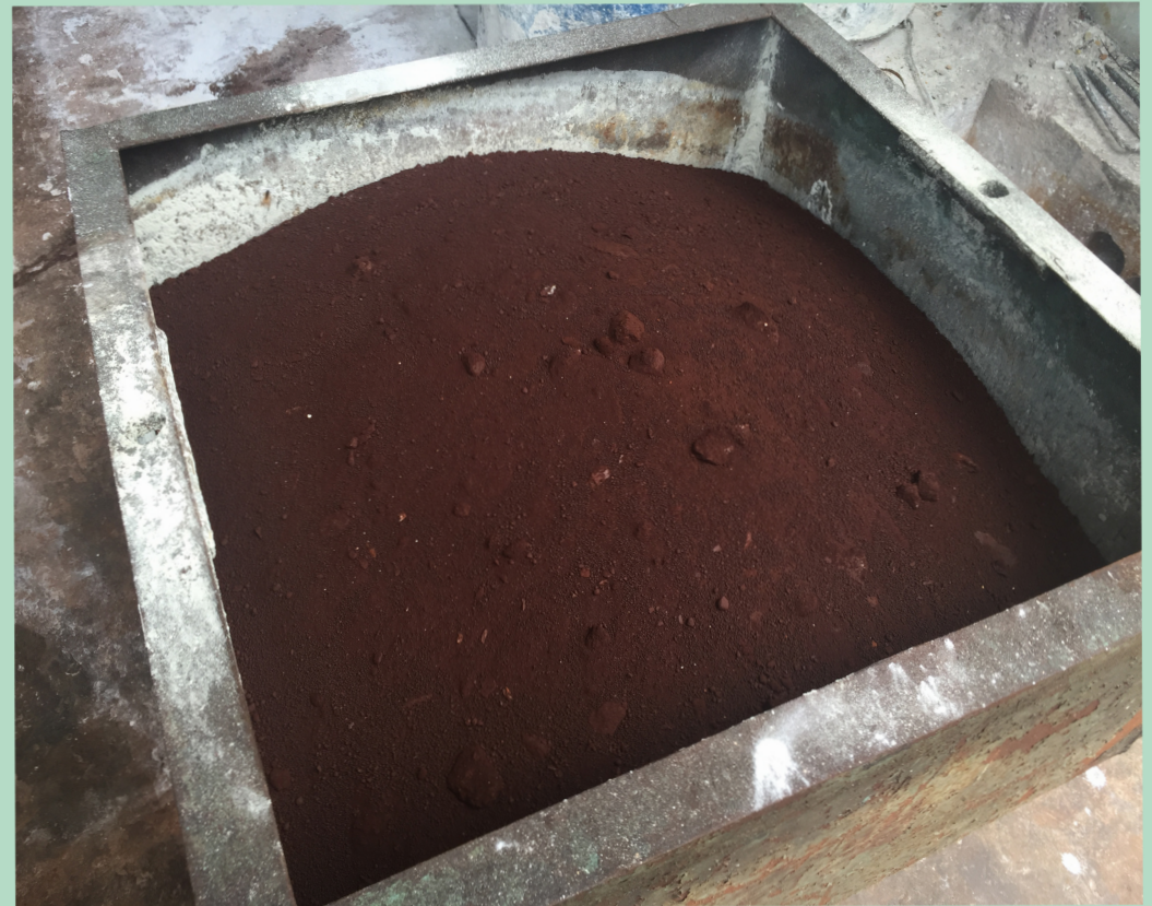
壓濾機壓濾後污泥----乾燥後
