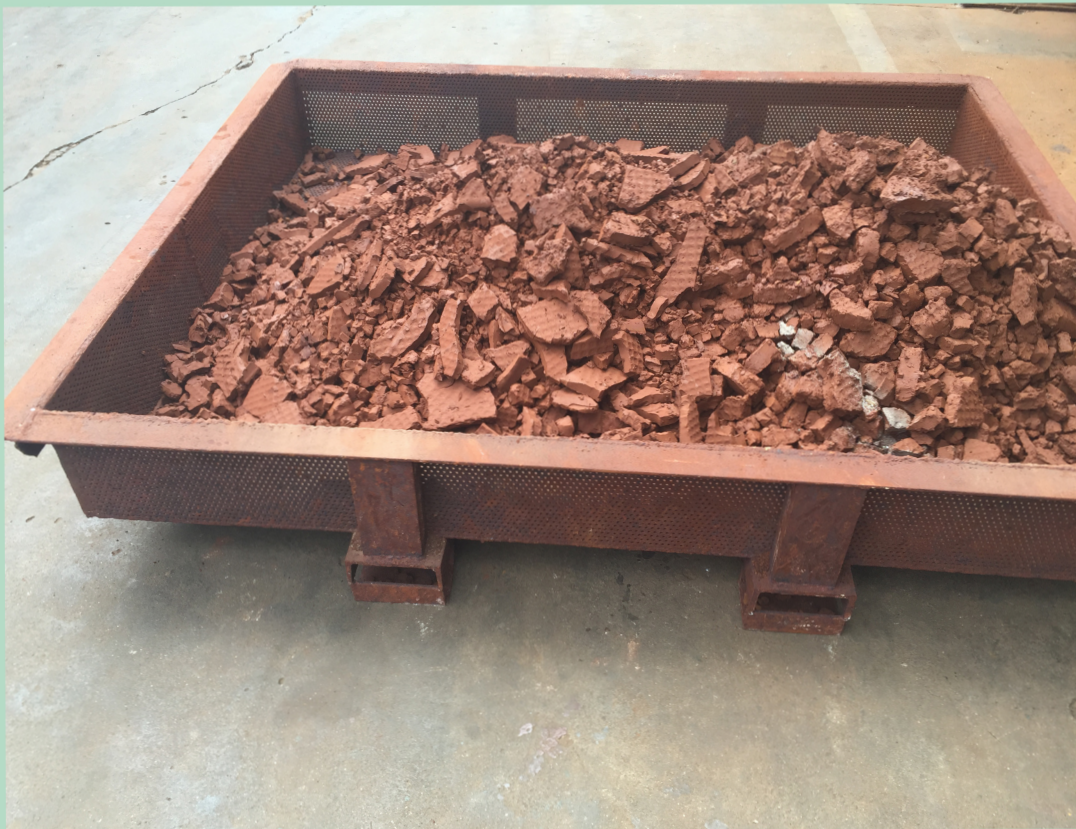
壓濾機壓濾後污泥----乾燥前
